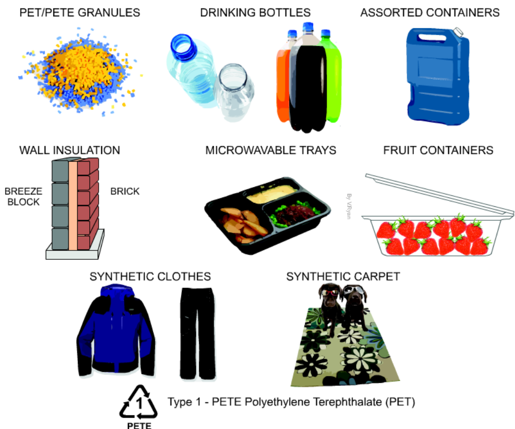
รูปที่ ก.1 ผลิตภัณฑ์จากพลาสติกชนิด พอลิเอทิลีน เทเรฟทาเลต (Ryan, 2021)
