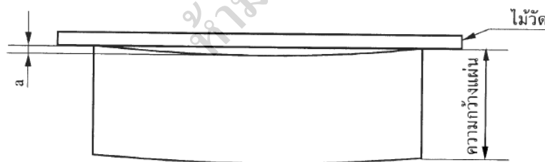
รูปที่ 4 การวัดระยะเบี่ยงเบนสูงสุดของขอบโค้งที่ด้านเว้า กรณีความยาวน้อยกว่า 2 000 mm (ข้อ 5.6)
